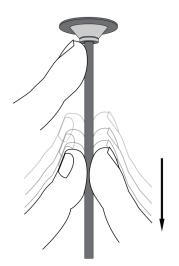
La longueur du câble est réglable. Pour régler le câble à la longueur souhaitée pour le luminaire, maintenez la coupole du luminaire contre le boîtier de prise électrique dans le plafond.
