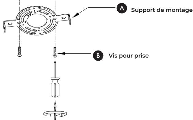
Fixez le support de montage A) avec des vis pour prise (B).
