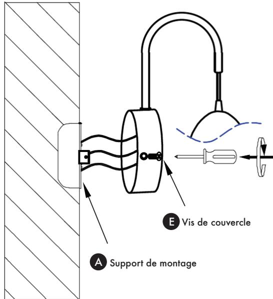
Attachez le couvercle au support de montage (A) avec les vis de couvercle (E).
