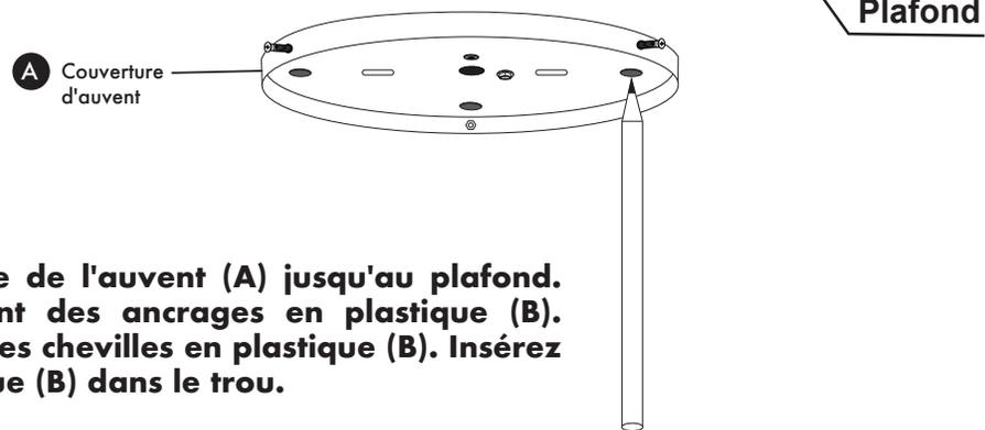
**Soulevez la couverture de l'auvent (A) jusqu'au plafond. Marquez l'emplacement des ancrages en plastique (B). Percez des trous pour les chevilles en plastique (B). Insérez les chevilles en plastique (B) dans le trou.**
