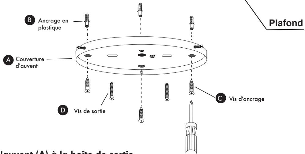
**Fixez le couvercle de l'auvent (A) à la boîte de sortie avec les vis de sortie (D). Vissez les vis d'ancrage (C) dans les ancrages en plastique (B) pour fixer la couverture de l'auvent (A).**
