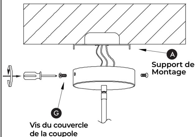
Fixez la coupole au support de montage (A) à l'aide des vis de la coupole (G).
