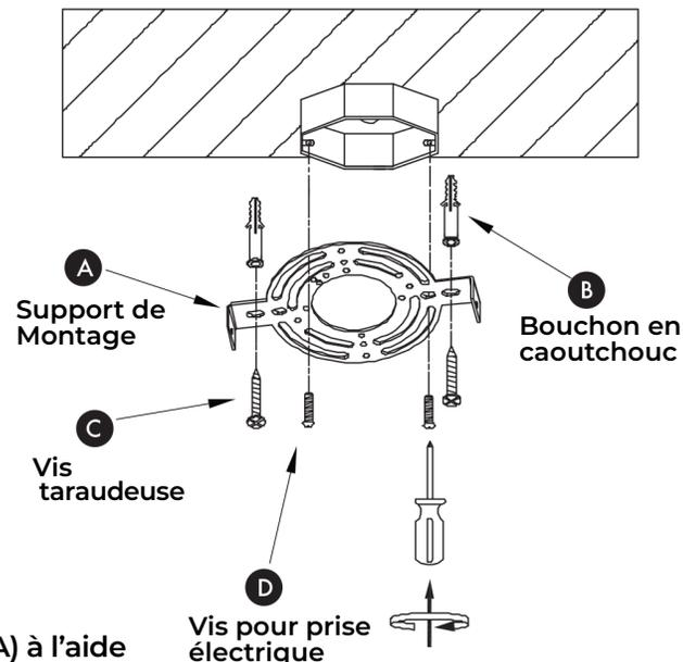
Fixez le support de montage (A) à l'aide des vis pour prise électrique (B), (C), (D).
