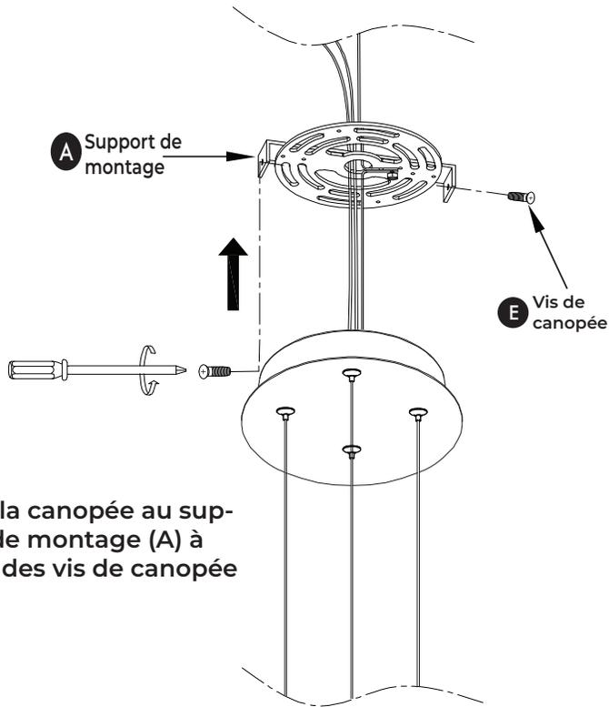
Fixez la canopée au support de montage (A) à l'aide des vis de canopée (E).
